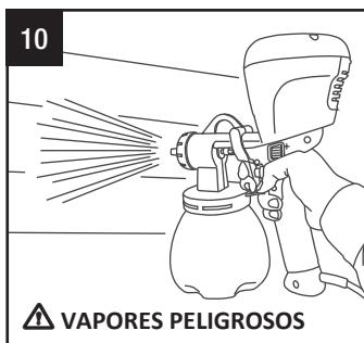
10. Rocíe la superficie manteniendo el pulverizador horizontal. Haga un movimiento de barrido y empalme.
