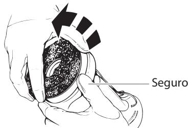
2. Mientras presiona el seguro del disco en la parte inferior de la unidad, enrosque el disco nuevo en la unidad en el sentido de las manecillas del reloj y ajústelo a mano.
